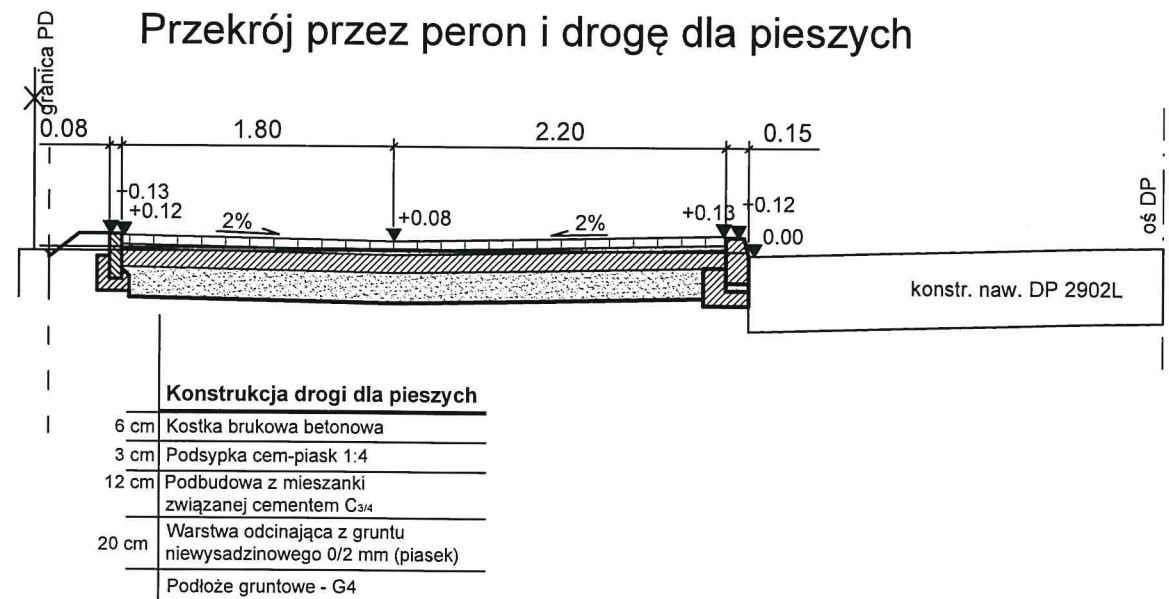
Przekrój typowy przez drogę dla pieszych przy krawędzi jezdni
